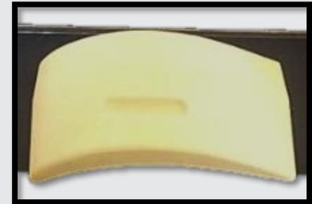
✓ セラミック コアはロストワックス製法で機械加工するには小さすぎる、または複雑すぎるキャビティを作製するために主に使用される犠牲セラミック構造です。
