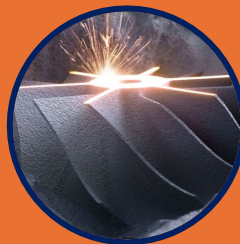
レーザービーム 使用のパウダー ベッド方式 (LPBF)
